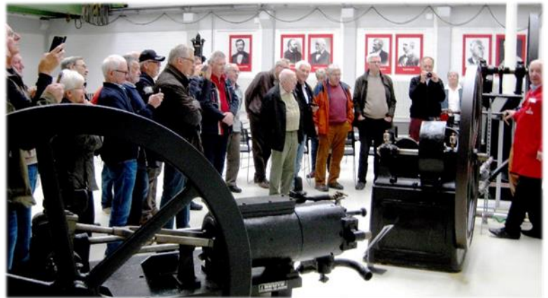
Der „Otto-Motor“, vorn der Versuchsmotor von 1876, rechts der betriebsbereite Serienmotor Typ A von 1878
